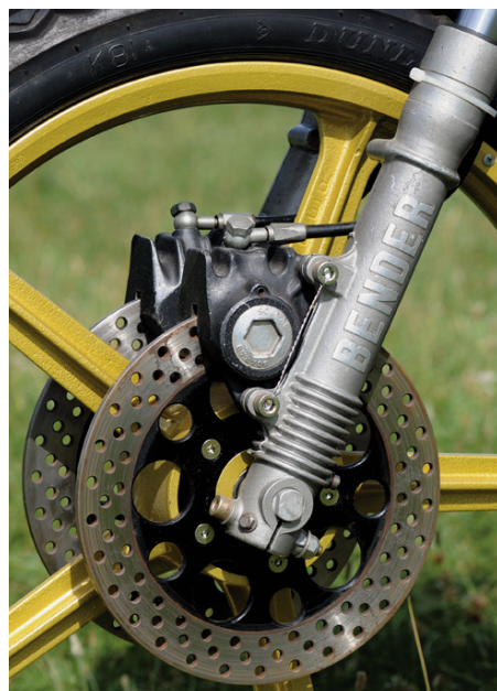
Eigenbau-Tauchrohre mit Kühlrippen, selbst gebaute Räder nebst Bremsscheiben
