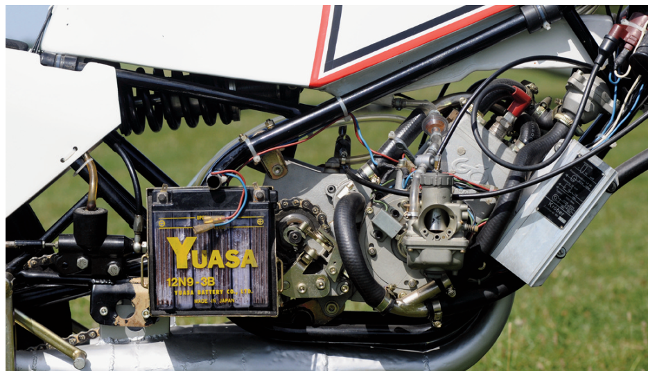
Doppelschleifenrahmen mit damals üblicher Cantilever-Federung
